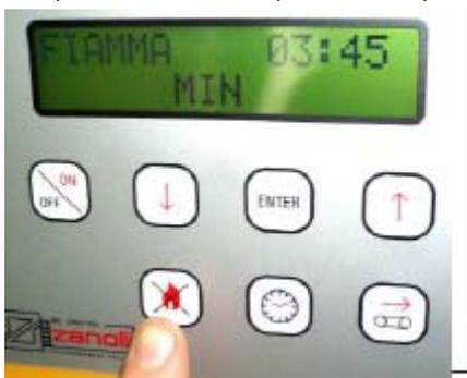
Если через 40-50 секунд на дисплее появится надпись "FLAME" (FIAMMA), проверьте, правильно ли подключена газовая труба и открыт ли газовый кран. Во время первого включения возможны неполадки в связи с наличием воздуха в газовых трубах.
